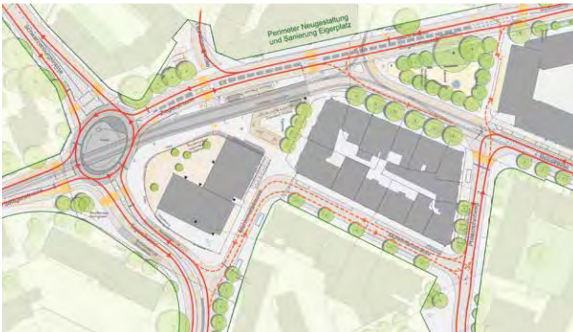
So ist die Verkehrsführung des motorisierten Individualverkehrs auf dem umgebauten Eigerplatz geplant.
